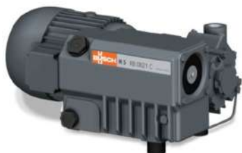
VacuÛmpomp. Pompe à vide. Capaciteit / capacité : 21m 3 /h Vermogen / puissance : 750W - 3F/400V Afmetingen / dimensions : 400 x 230 x 180 mm Filter inclusief / filtre inclus Gewicht / poids : 20 kg Ref. 09-3013
