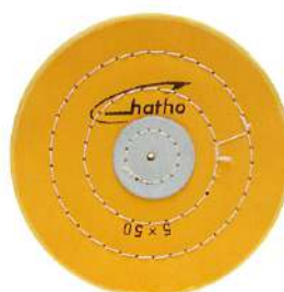
Linnenschijf hard geel met lederen kern. Dubbel gestikt, geschikt voor polijsten algemeen. Disque en toile jaune dur avec centre en cuir. Double cousu, pour le polissage en général. 150 x 15 mm Ref. 02-27101
