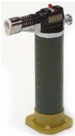
Microvlambrander Proxxon. Opvulbaar met aanstekergas. Autonomie bij volledige vulling : ca 2 uur. Micro bruleur Proxxon. Rechargeable. Autonomie de ca. 2 heures avec recharge complète. Max. temperatuur : 1300°C. Ref. 26-140
