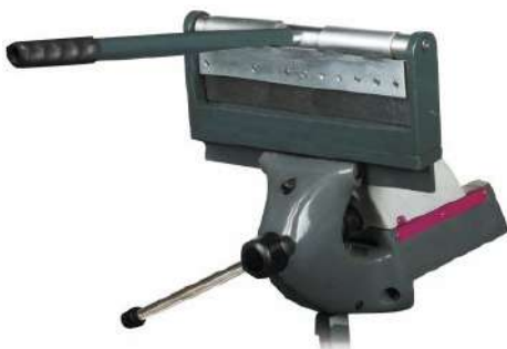
Manuele plooiemachine. Zetbankje voor het buigen en plooiën van platen. Met uitneembare segmenten van 25,50,75 en 150 mm. Breedte : 300 mm. Max. plaatdikte : 2 mm. Te bevestigen in een bankschroef. Appareil à plier. Pliieuse permettant le pliage des tôles fines. Segment variable amovible de 25,50,75 et 150 mm. Largeur : 300 mm. Épaisseur tôle max. : 2 mm. À fixer dans un étau de table. Ref. 24-341
