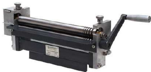
Rolapparaat . Toestel met drie cilindres voor het rollen van plaat en buis. Max. plaatdikte : 2 mm. Buis/draadcapaciteit : 1 - 5 mm. Lengte : 300 mm. Te bevestigen in een bankschroef. Appareil à enrouler. Avec 3 cylindres pour plier des plaques et tubes. Épaisseur max. : 2 mm. Capacité fil/tube : 1 - 5 mm. Longueur : 300 mm. À fixer dans un étau de table. Ref. 24-340
