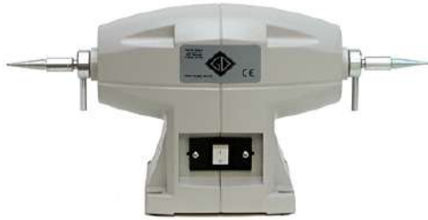
Polijstmotor 1 snelheid MAP-1. Moteur à polir 1 vitesse MAP-1. 2800 rpm - 500 Watt. 52 x 12 x 23,5 cm Gewicht / Poids : 10 kg. Ref. 19-168
